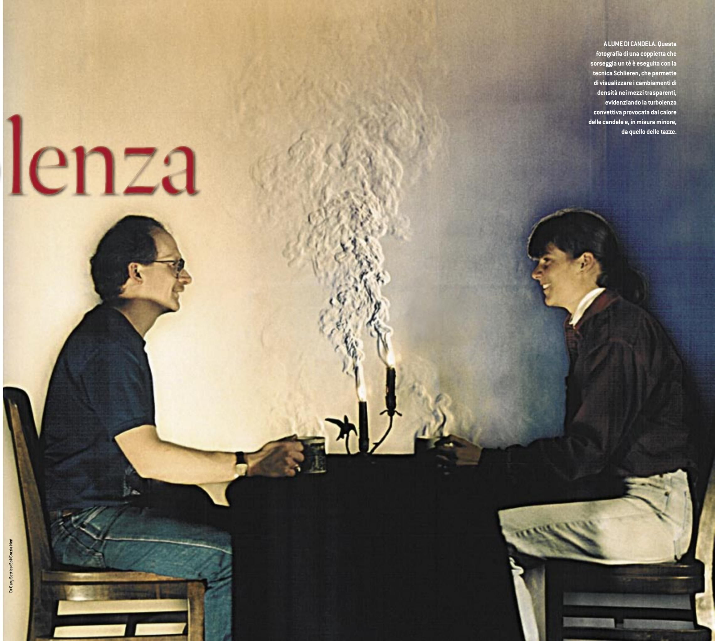
A LUME DI CANDELA. Questa fotografia di una coppia che sorseggia un tè è eseguita con la tecnica Schlieren, che permette di visualizzare i cambiamenti di densità nei mezzi trasparenti, evidenziando la turbolenza convettiva provocata dal calore delle candele e, in misura minore, da quello delle tazze.
