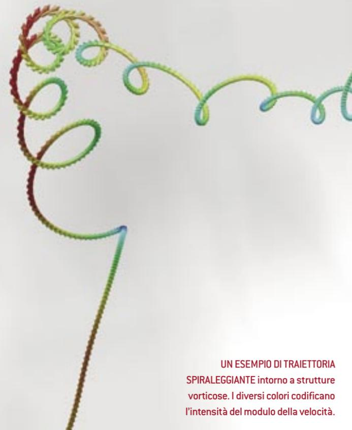
UN ESEMPIO DI TRAIETTORIA SPIRALEGGIANTE intorno a strutture vorticosi. I diversi colori codificano l'intensità del modulo della velocità.
